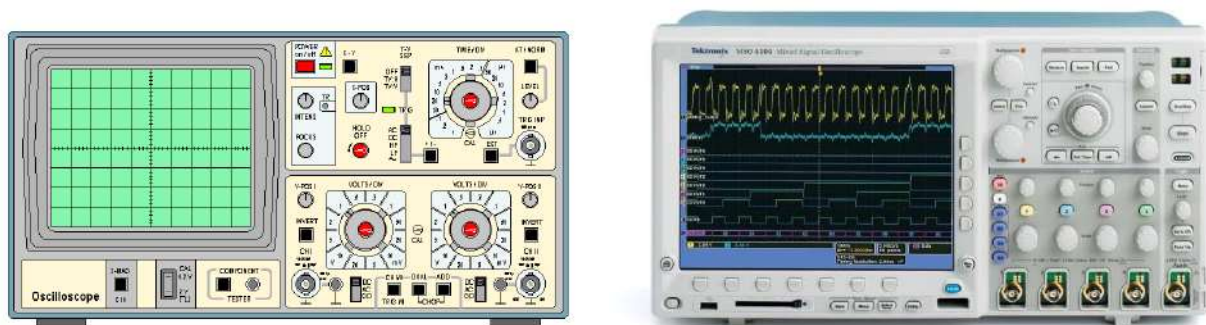
Figuur 6 Links: analoge oscilloscoop (schematisch), rechts: moderne digitale oscilloscoop
