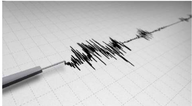
Figuur 11 Een seismograaf waarmee trillingen van de aardkorst worden geregistreerd.
