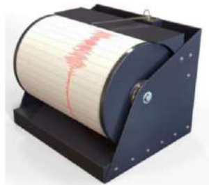
Figuur 9 Een seismograaf waarmee trillingen van de aardkorst worden geregistreerd.
