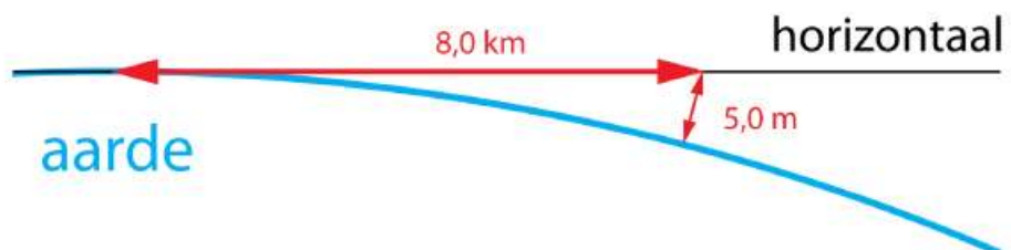
Figuur 28 Kromming van de aarde. Na 8,0 km ligt het oppervlak van de aarde 5,0 m onder de horizon.
