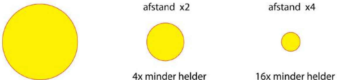
Figuur 60 De helderheid waarmee een ster wordt waargenomen neemt af met het kwadraat van de afstand.
