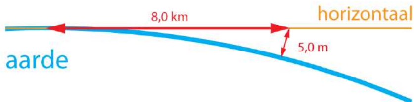
Figuur 22 Na 8,0 km ligt het oppervlak van de aarde 5,0 m onder de horizon.
