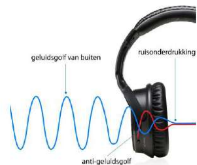
Figuur 31 Actieve ruisonderdrukking.
