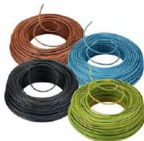
Figuur 53 Installatiedraad: fasedraad (bruin), nuldraad (blauw), aarddraad (geelgroen) en schakeldraad (zwart).
