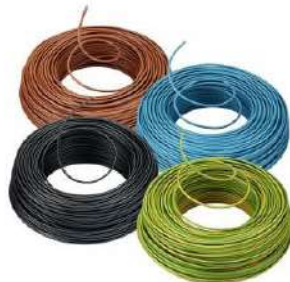
Figuur 43 Installatiedraad: fasedraad (bruin), nuldraad (blauw), aarddraad (geelgroen) en schakeldraad (zwart).
