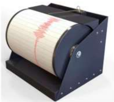
Figuur 11 Een seismograaf waarmee trillingen van de aardkorst worden geregistreerd.
