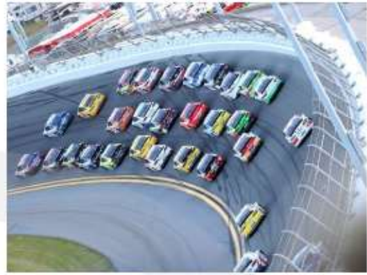
Figuur 15 In de weg wordt een hellende bocht gemaakt, waardoor de bocht met een grotere snelheid kan worden genomen.
