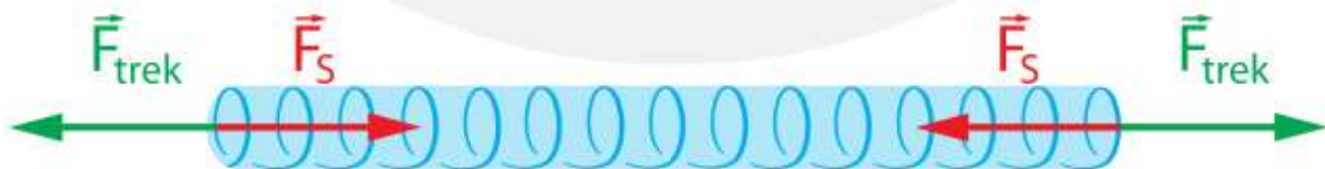
Figuur 28 Een kracht wordt uitgeoefend op een koord waardoor het koord wordt gespannen. Hierdoor ontstaat er een spankracht F_S die aan beide uiteinden even groot is.
