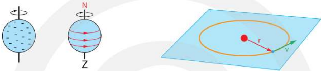
Figuur 24 Magnetisme wordt voornamelijk veroorzaakt door de inwendige "spin" van de elektronen (links) en doordat elektronen om de atoomkernen bewegen (rechts).
