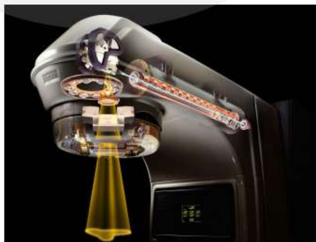
Figuur 23 Lineaire elektronenversneller gebruikt voor bestraling bij radiotherapie. Bovenin zie je de elektronenversneller die in dit geval uit even lange buisjes bestaat.
