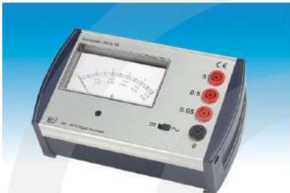
Figuur 22 Stroommeter met drie meetbereiken: Boven: maximaal 5 A Midden: maximaal 0,5 A Onder: maximaal 0,05 A
