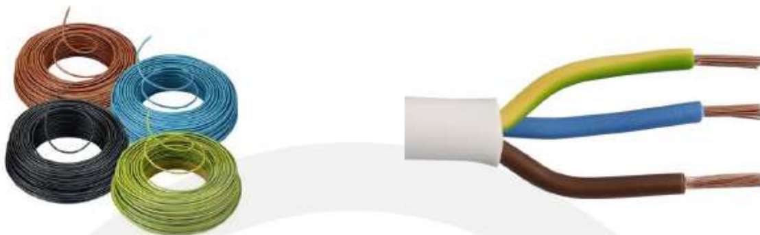
Figuur 66 Installatiedraad: fasedraad (bruin), nuldraad (blauw), aarddraad (geel-groen) en schakeldraad (zwart).
