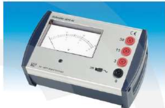
Figuur 23 Spanningsmeter met drie meetbereiken: Boven: maximaal 30 V Midden: maximaal 15 V Onder: maximaal 3 V
