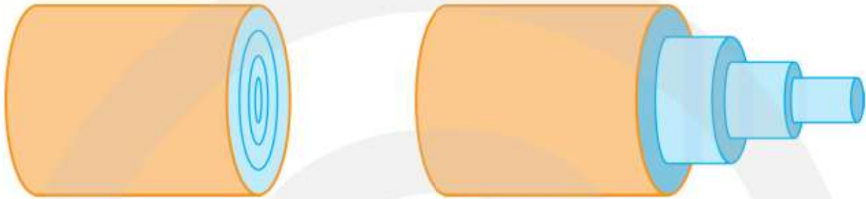
Figuur 17 Links, ideale vloeistof, waarin de snelheid van de vloeistof overal in de buis hetzelfde is. Rechts, vloeistof met viscositeit, waarbij de snelheid in het centrum van de buis groter is dan de snelheid bij de wand.
