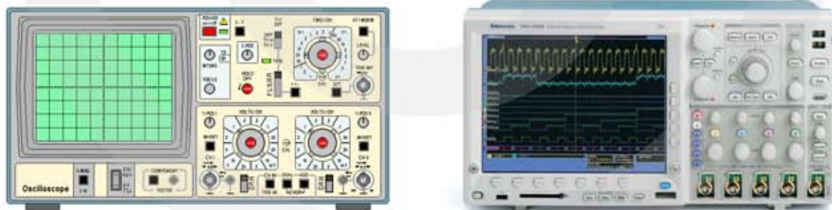
Figuur 9 Links: analoge oscilloscoop (schematisch), rechts: moderne digitale oscilloscoop
