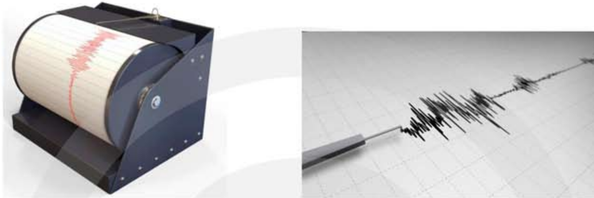
Figuur 14 Een seismograaf waarmee trillingen van de aardkorst worden geregistreerd.
