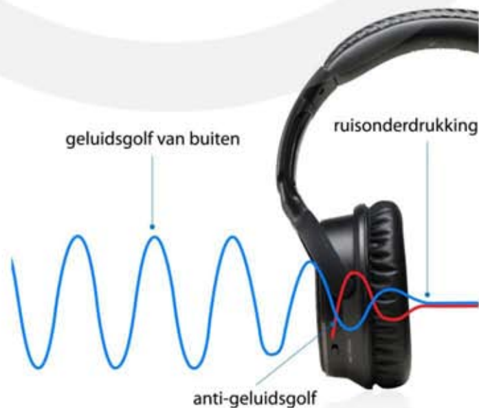
Figuur 37 Actieve ruisonderdrukking is gebaseerd op antigeluid.
