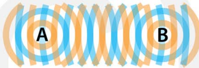
Figuur 38 Een staande golf is aanwezig tussen de trillingsbronnen A en B.
