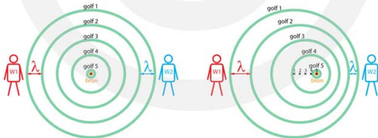
Figuur 62 Het dopplereffect. Links staat de bron stil. Rechts beweegt de bron van waarnemer W1 vandaan en naar waarnemer W2 toe. Waarnemer W1 ziet een grotere golflengte en W2 een kleinere golflengte. Voor W1 verschuift het spectrum naar het rood en voor W2 naar het blauw.
