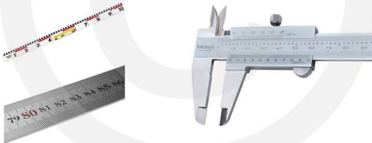
Figuur 11 Instrumenten om afstanden (lengtes) te meten. Linialen (links) en schuifmaat (rechts).
