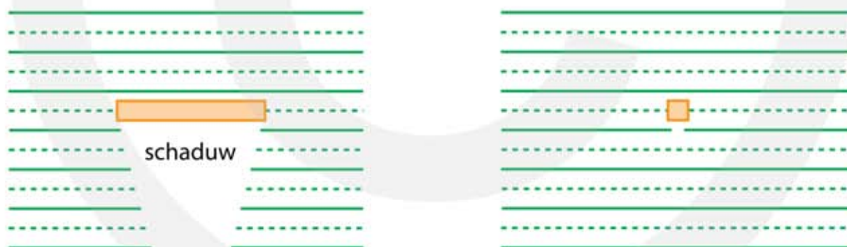
Figuur 1 Links: Een lichtgolf komt een object tegen groter dan de golflengte. Bij de randen buigt het licht een beetje af. Achter het object ontstaat een schaduw. Rechts: Achter een object kleiner dan de golflengte ontstaat geen schaduw, het licht gaat ongestoord verder.
