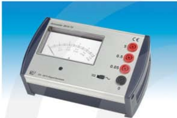
Figuur 21 Stroommeter met drie meetbereiken: Boven: maximaal 5 A Midden: maximaal 0,5 A Onder: maximaal 0,05 A
