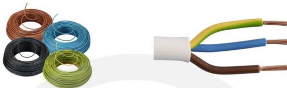
Figuur 53 Installatiedraad: fasedraad (bruin), nuldraad (blauw), aarddraad (geel-groen) en schakeldraad (zwart).
