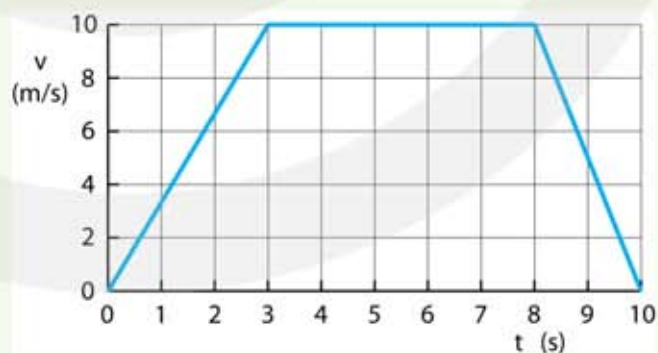
Figuur 40 Het (v, t)-diagram afgeleid uit de figuur 39.
