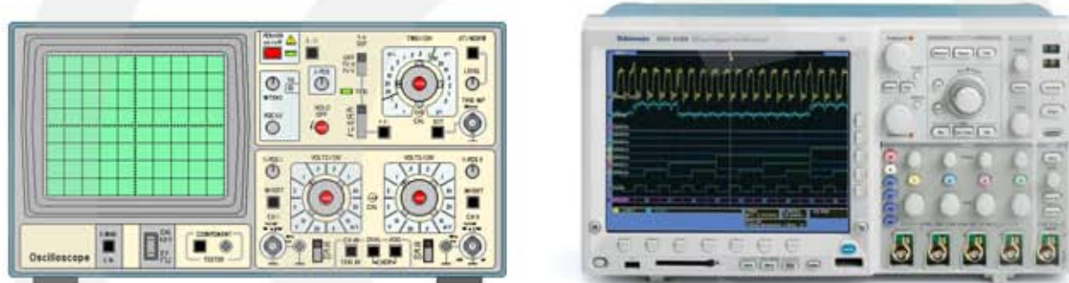
Figuur 6 Links: analoge oscilloscoop (schematisch), rechts: moderne digitale oscilloscoop
