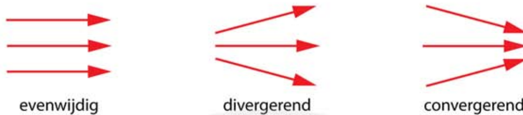
Figuur 4 Lichtbundels kunnen evenwijdig zijn, divergerend (van elkaar af) of convergerend (naar elkaar toe).
